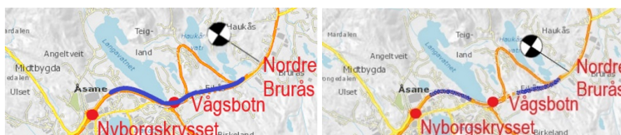
Figur 2-5 I det venstre utsnittet vises sammenhengende feltreservasjon (blå strek) fra sør for Nordre Brurås frem mot Nyborgskrysset. Etter trafikksimuleringen anbefales det at delstrekningen deles i to som vist i det høyre utsnittet
