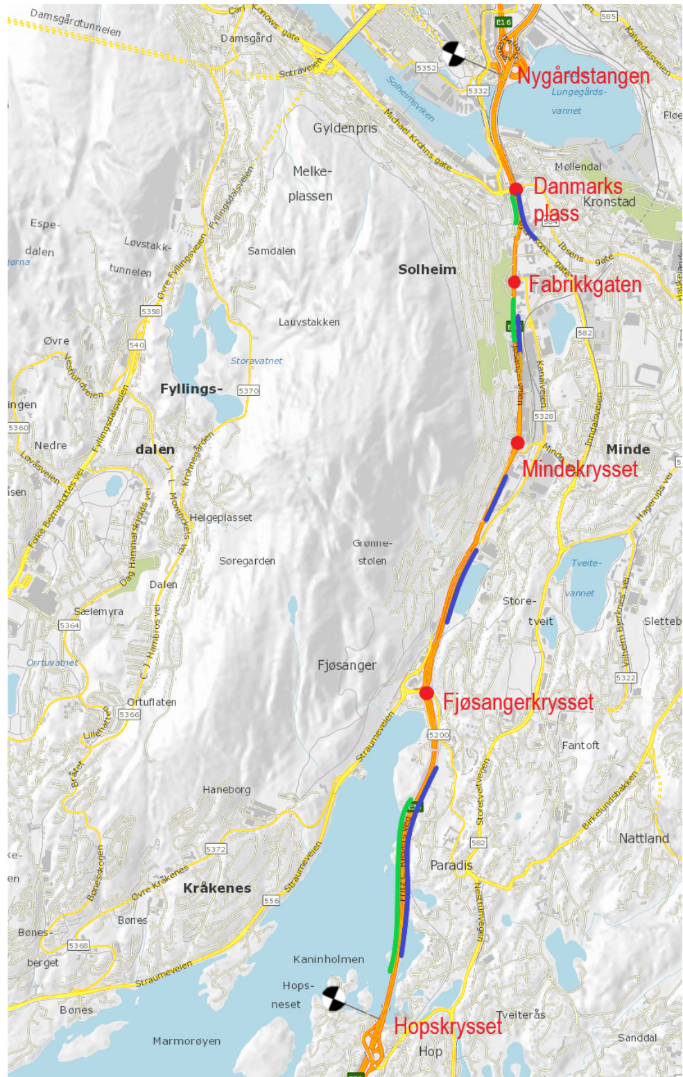
Figur 2-3 Delstrekninger på søndre innfartsåre der feltprioritering anbefales vurdert nærmere. Grønn og blå strek markerer feltprioritering hhv. fra og mot Bergen sentrum. Kilde for grunnlagskartet er https://www.vegvesen.no/veqkart
